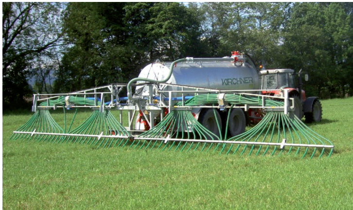
Bodennahe, geruchsarme Gülleausbringung.
